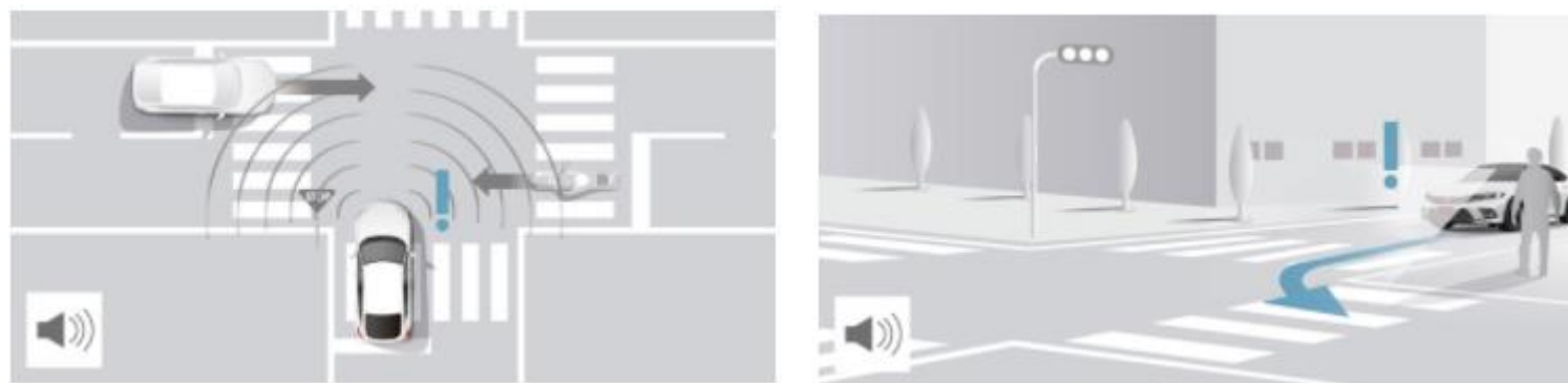
衝突軽減ブレーキシステム：交差点での右左折をサポート (Collision Mitigation Braking System Supporting Right/Left Turns at Junctions)
